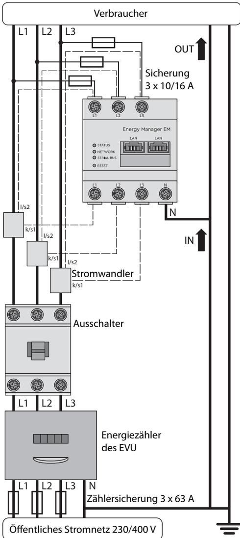
Abbildung: Anschluss bei direkter Messung
